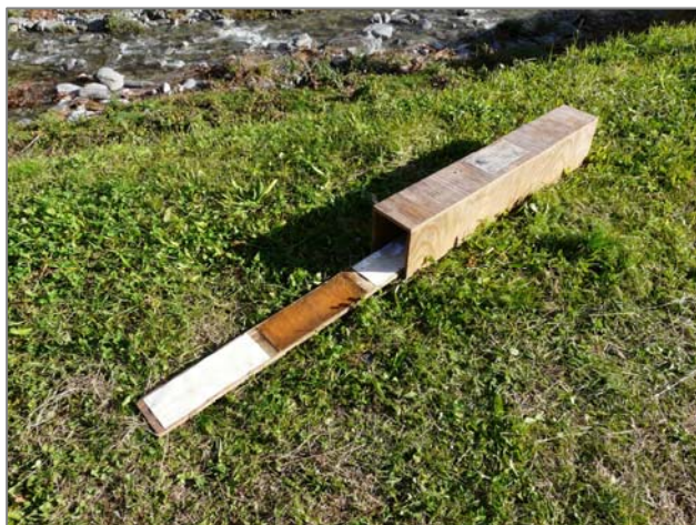
Fig. 1: Il tunnel per le tracce con l'asse estraibile.
